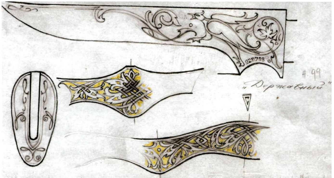
Рис. 1.14. Эскиз всечки на клинке, верхней стороне обоймицы и работы с насечным фоном на обоймице и навершии ножа «Державный». Размер листа 165x88 мм
