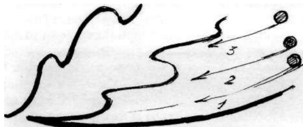
Рис. 1.64. Золочение. Направление и начало набивки проволоки
