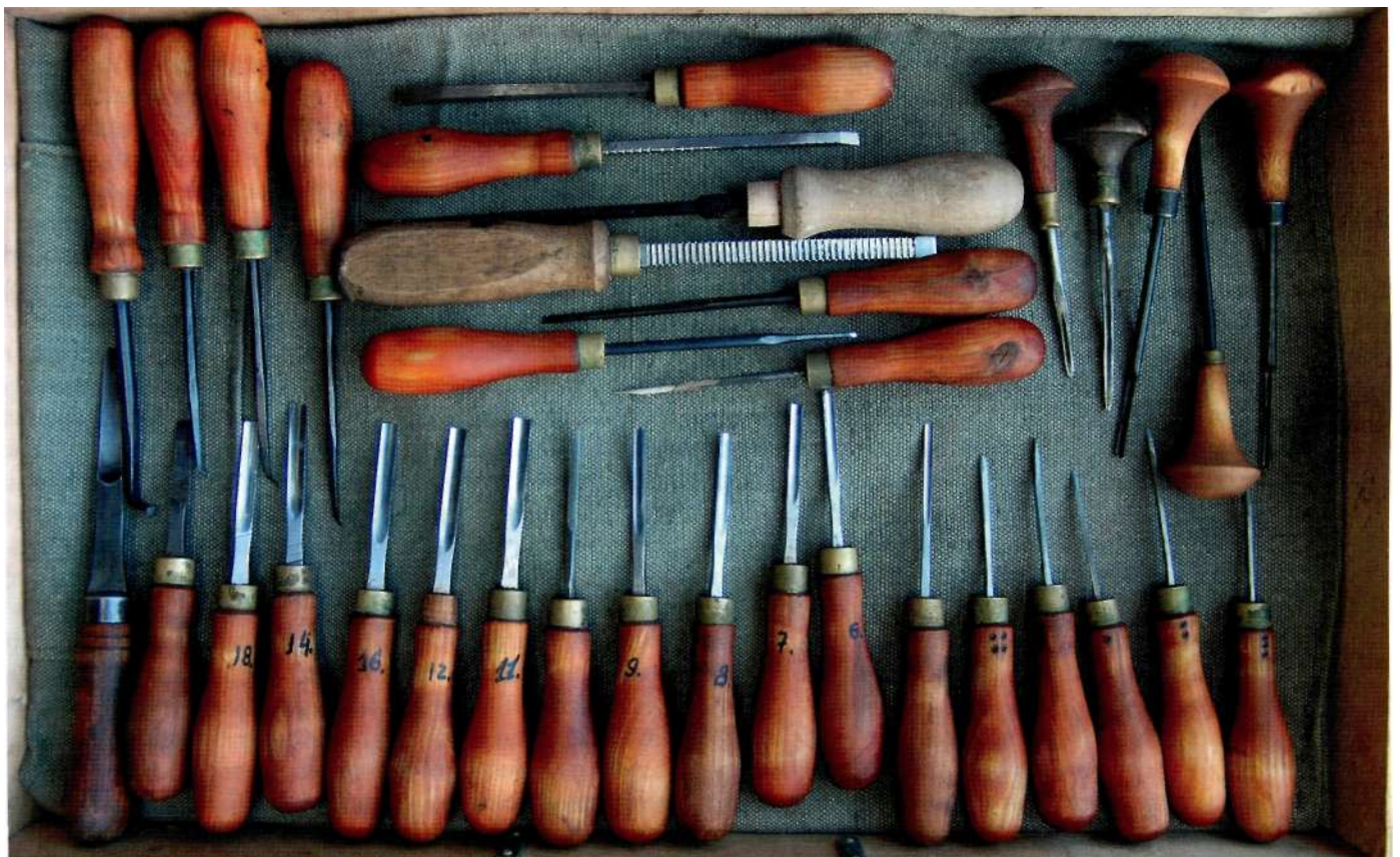
Фото 4.4. Инструмент для резьбы по дереву. Нижний ряд — полукруглые стамески с внешней заточкой рабочей части (18 шт.), выше слева направо: «сапожки» (4 шт.), плоские стамески (7 шт.), уголки (5 шт.)
