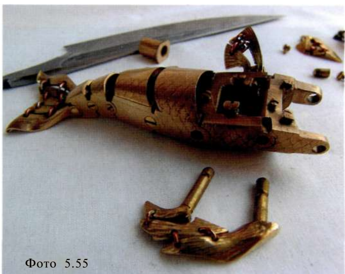
На осях плавника видны пазы под винты с конусной заточкой
