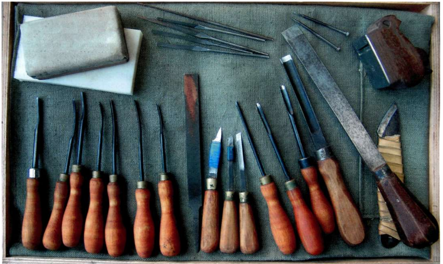
Фото 4.3. Инструмент для резьбы по дереву. Нижний ряд — клюкарзы (7 шт.), напильник, зубная щетка, ножи-косячки (3 шт.), полукруглые стамески с внутренней заточкой рабочей части (4 шт.), плоская стамеска, матуары (2 шт.), резак. Выше, слева направо: деревянная подушка, обтянутая тонкой кожей, пластик для работы с проволокой для инкрустации, надфили, стружок (маленький рубанок)
