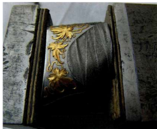
Фото 1.97. Деталь прибора ножен, на которой делается насечка, залитая сплавом вуда
