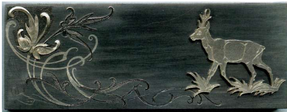
Фото 2.32. Фигурка приклеена быстросохнущим клеем и обведена чертилкой
