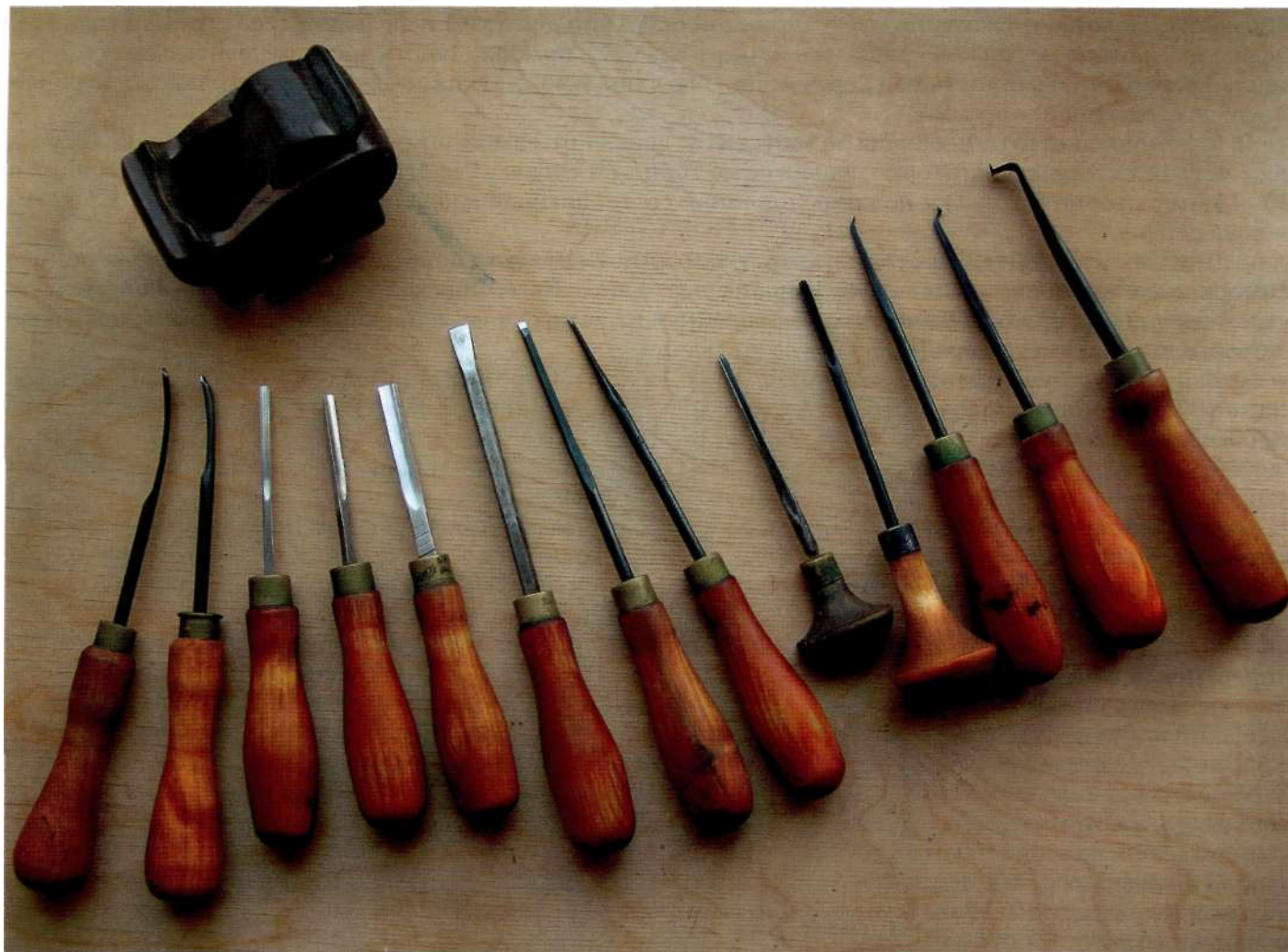
Фото 4.2. Инструмент для работы по дереву. Слева направо: радиусные стамески (с загнутой рабочей частью — клюкарзы — 2 шт. и с ровной — 3 шт.), плоские стамески (3 шт.), уголки (2 шт.), стамески — «сапожки» (3 шт.). Сверху — рубанок
