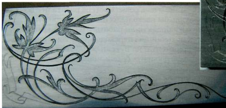
Фото 2.5. Вид в ракурсе. Выбирать фон необходимо так, чтобы плоскость была очень ровной. От этого зависит качество получаемого впоследствии замка на плоскости
