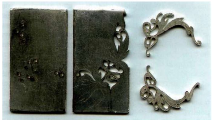
Фото 1.158. Элементы размечены на пластине и выпилены
