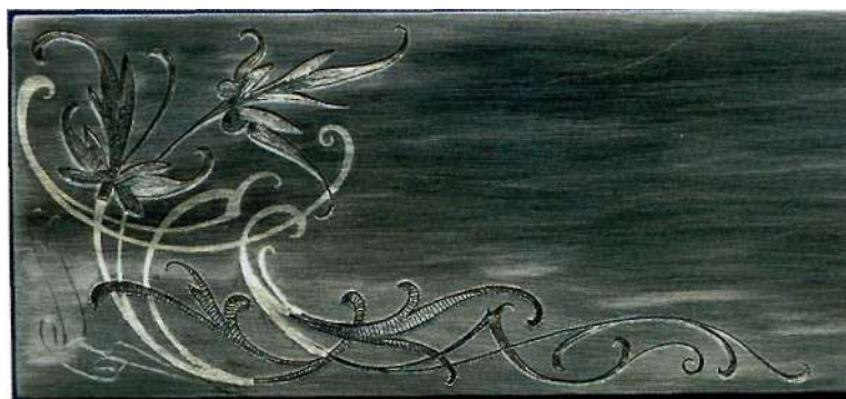
Фото 2.16. Всечка зачищена наждачной бумагой и ей же заполирована
