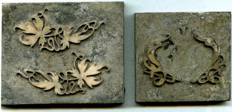
Фото 1.159. Элементы припаяны к пластинам на олово
