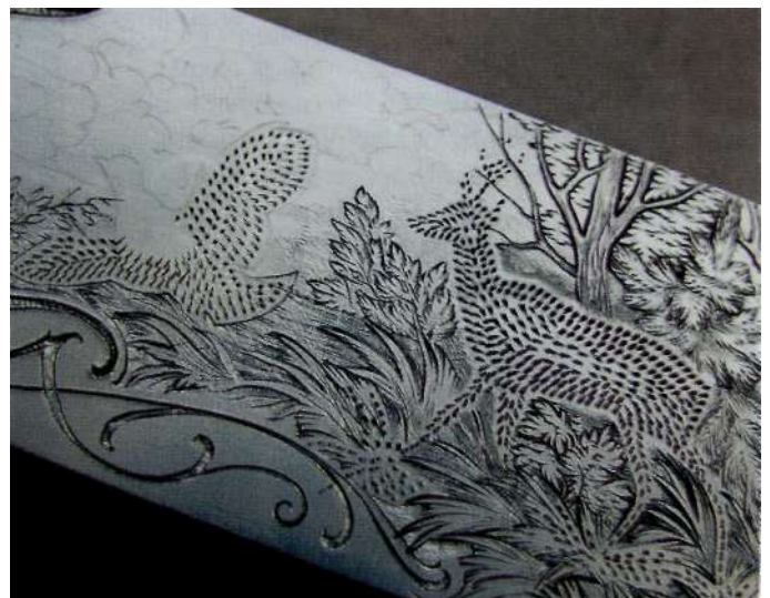
Фото 2.39 (а, б). Вид в ракурсе. На фотографиях видно, в каких направлениях гравироваются шипы замка
