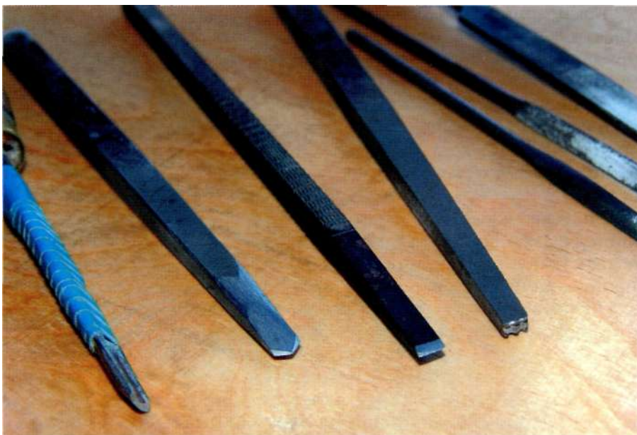
Фото 5.44. Формы рабочих поверхностей резцов
