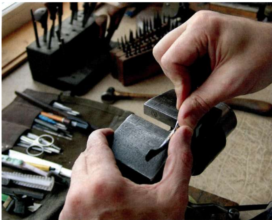
Фото 1.12. Работа рук «в распор» при гравировке штихелем
