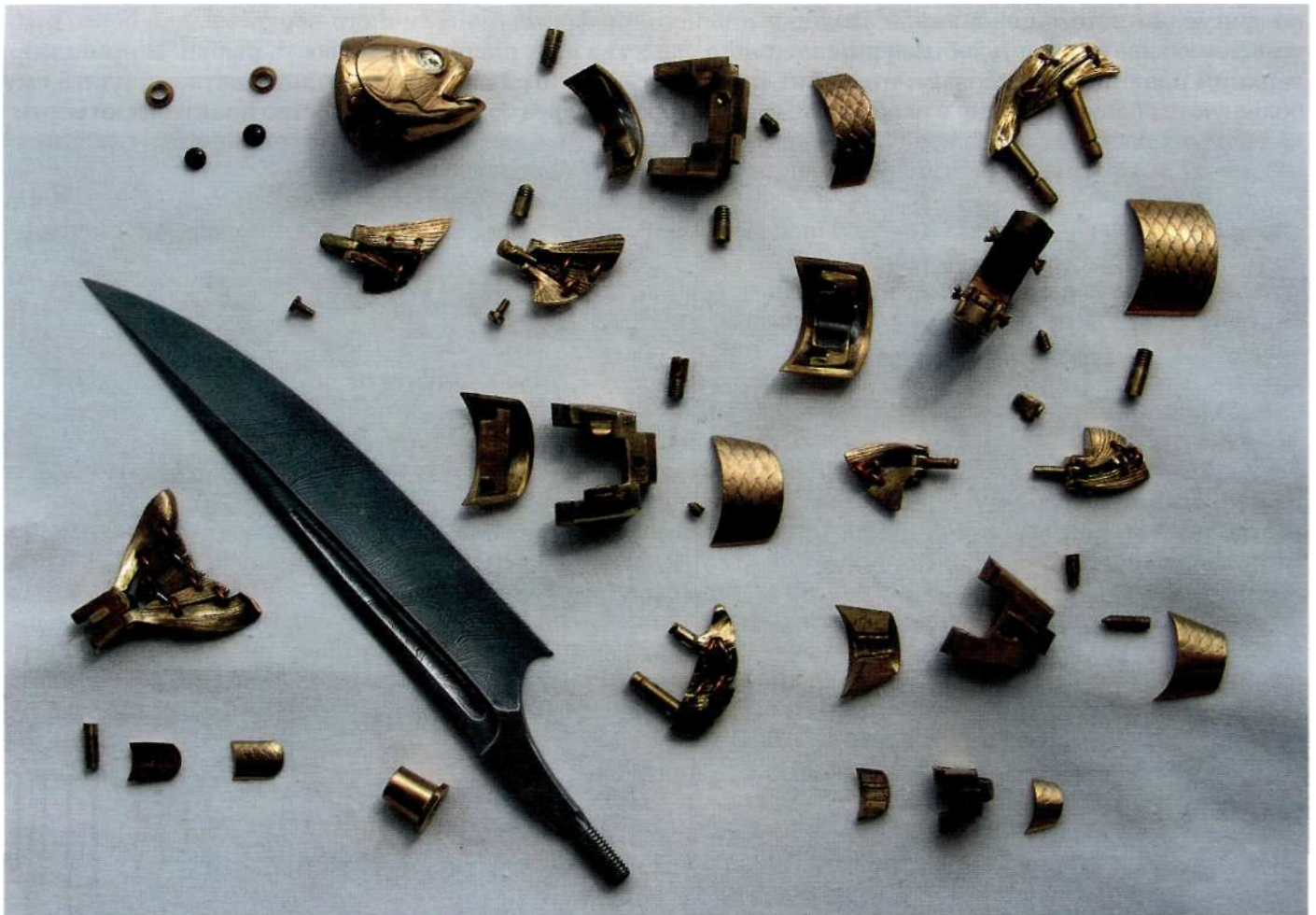
Фото 5.49. Полная разборка ножа «Рыбка»
